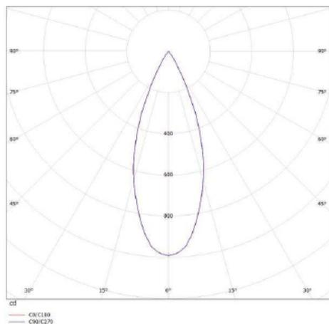
Die Werte sind Bemessungswerte. Leistung und Lichtstrom unterliegen initial einer Toleranz von +/- 10%. Toleranz der Farbtemperatur: +/- 150 K. Die Werte gelten wenn nicht anders angegeben für eine Umgebungstemperatur von 25°C.
